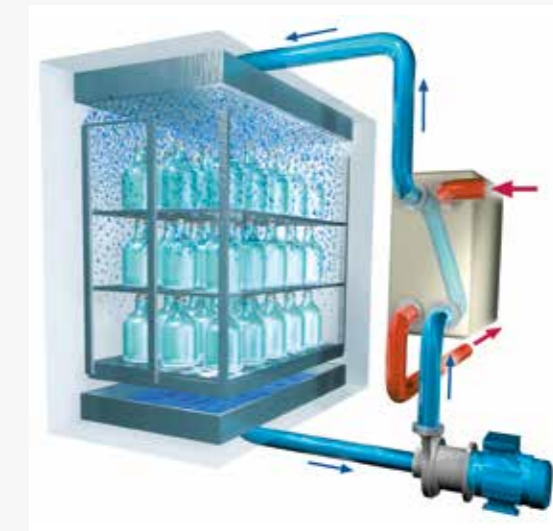
Proces z wykorzystaniem kaskady gorącej wody
